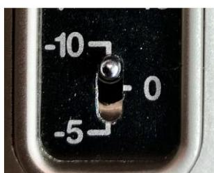
Ein weiterer Schalter, das sogenannte **Pad**, den Du eventuell auch an Deinem Mikrofon hast, bedeutet, dass Du für besonders laute Instrumente wie z. B. Schlagzeug oder E-Gitarre die Empfindlichkeit herabsetzen kannst, damit das Mikrofonsignal nicht verzerrt. Für die meisten Situationen benötigen wir diese Einstellung jedoch nicht.
